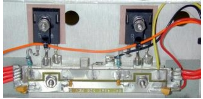
FET DC Switch and Buss Bar
